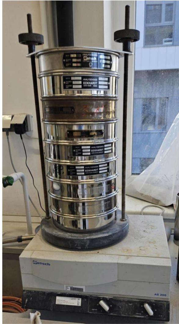
*Abbildung 49. Ausführung der Siebung*
