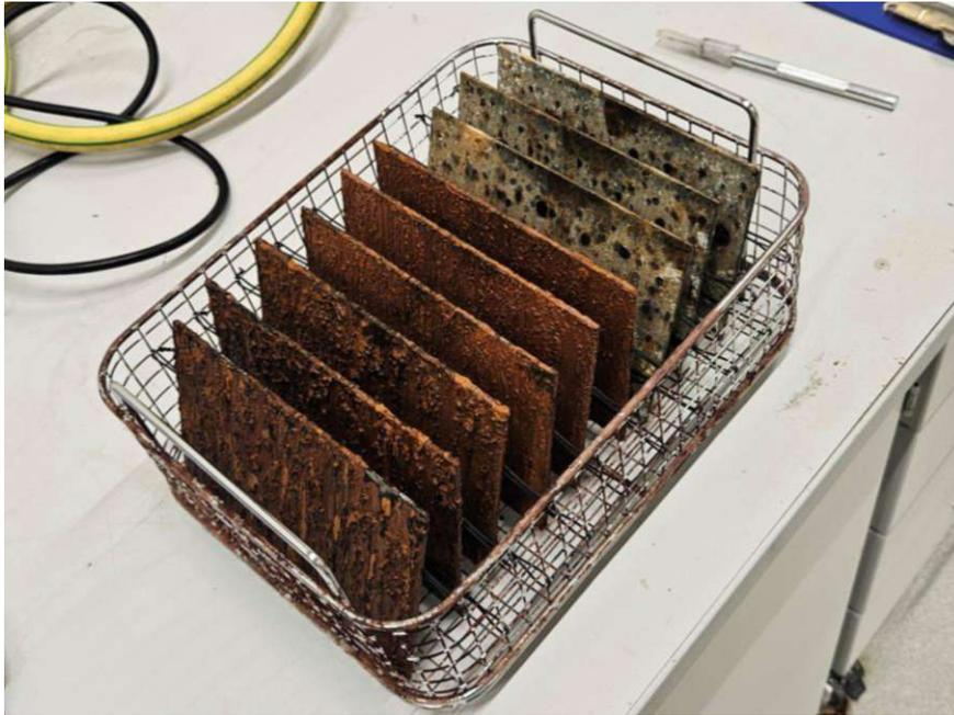
*Abbildung 70. Vorbereitung Ultraschallbad: Stahlplatten im Ständer platziert*
