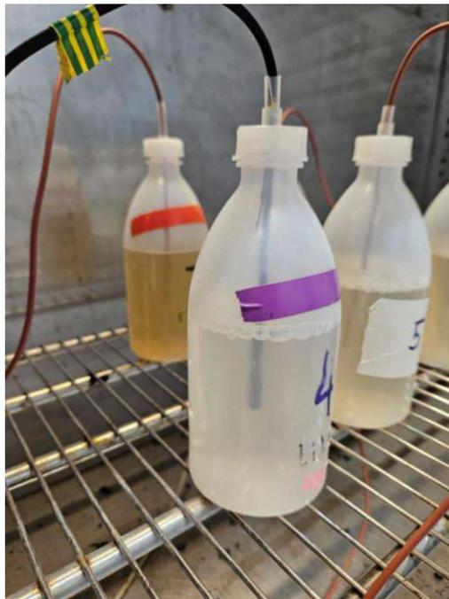
Abbildung 29. Temperaturfühler in die Kunststoffflasche ordnungsgemäß positioniert.
