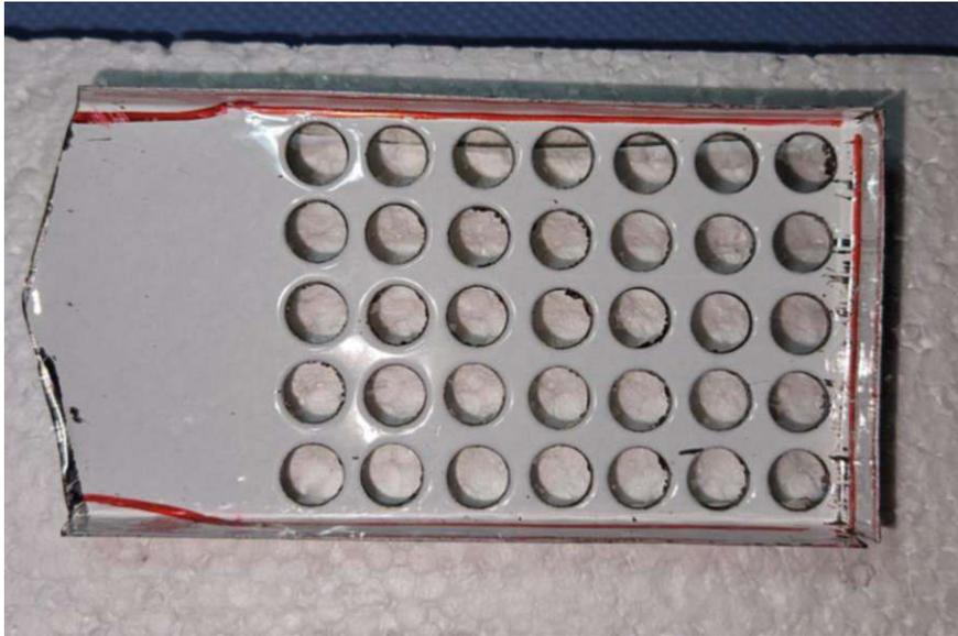
Abbildung 9. Zwischengefäß zur Übertragung der Taumittel ins Eisgefäß
