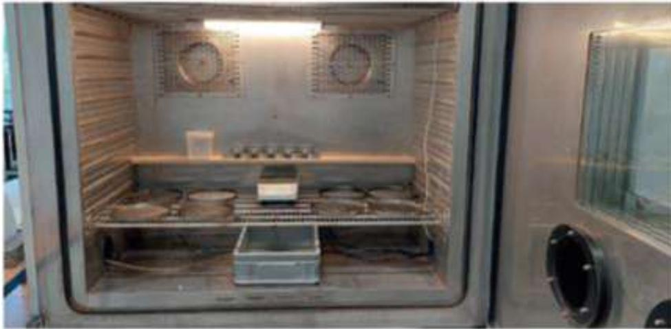
Abbildung 5. Versuchsaufbau im Klimaschrank nach SHRP Methode H-205.1/2
