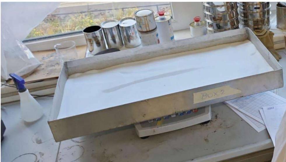
Abbildung 59. Befeuchtung der Taumittel: Sprühflasche(links) und angemessener Box(rechts)
