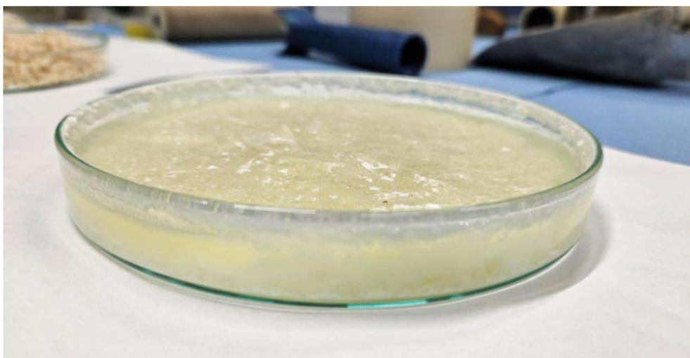
Abbildung 45. Taumittel D - Bildung der Oberflächenschicht während der Trocknungsprozesses
