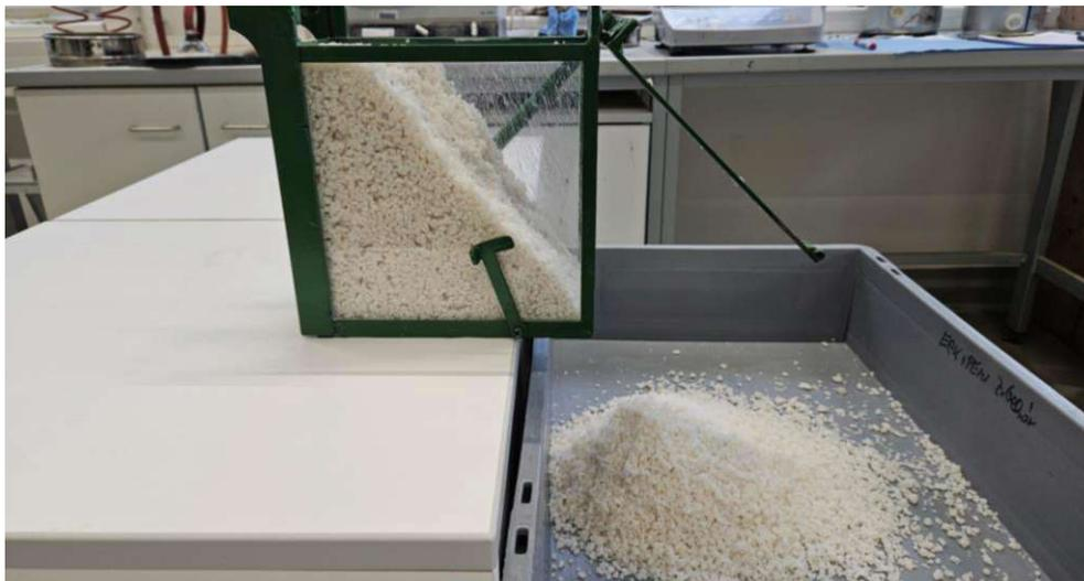
Abbildung 57. Rieserversuch nach Auslauf des Taumittels
