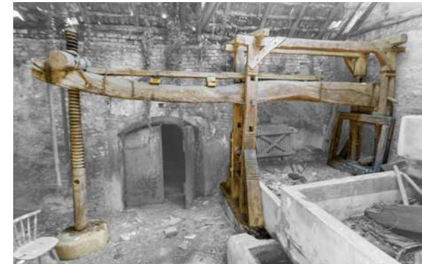
Abb. 4.203: Kirchberg, Mühlweg. Baumpresse in einem stark desolaten traufständigen Presshaus.
