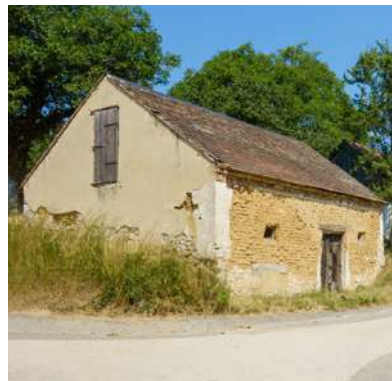
Abb. 4.190: Nodendorf, Gaisbüglweg . Satteldach mit ausgemauerten Giebel. Im Giebel befindet sich hier das sogenannte „Heutürl“.
