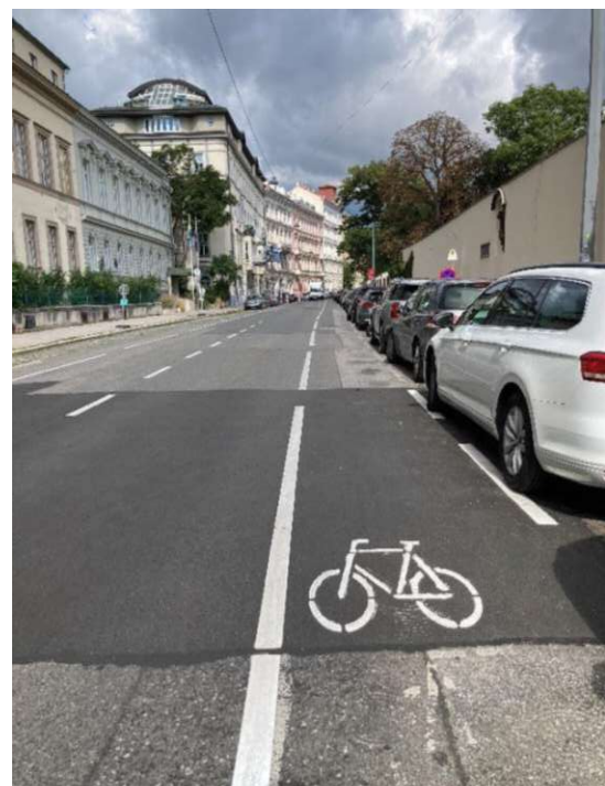
Abbildung 26: Gefahr des „Dooring“ entlang Liechtensteinstraße 9. Bezirk?; eigene Aufnahme
