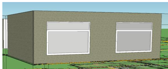
Abbildung 5: 3D Modell IDA ICE für ein Klassenzimmer mit kippbaren Oberlichtfenstern (Quelle: e7, 2023)
