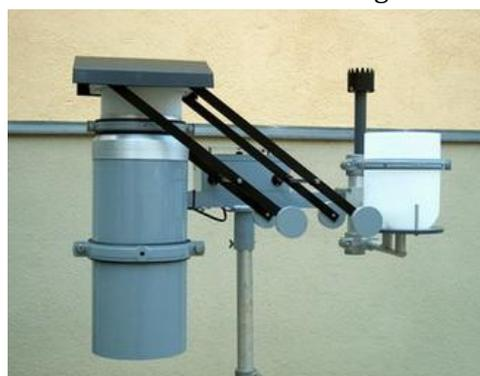
**ABBILDUNG 3:** ('WADOS - WET AND DRY ONLY PRECIPITATION SAMPLER')
