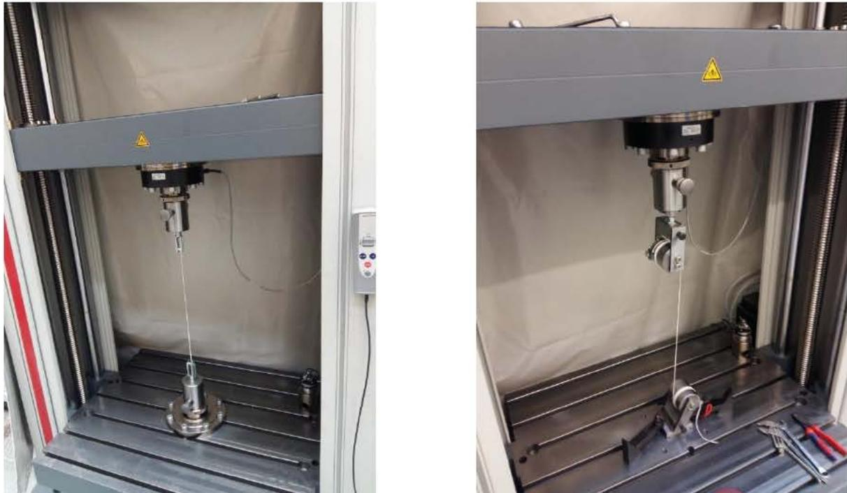
Abbildung 22: Zugprüfversuch Kiteline gespleißt (links), ungespleißt (rechts)
