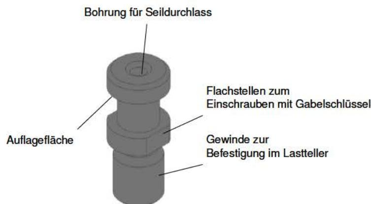
Abbildung 65: Verriegelungsbolzen
