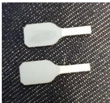
Abbildung 30 zeigt den gebrochenen Schulterstab der Referenzprobe aus TH37.
