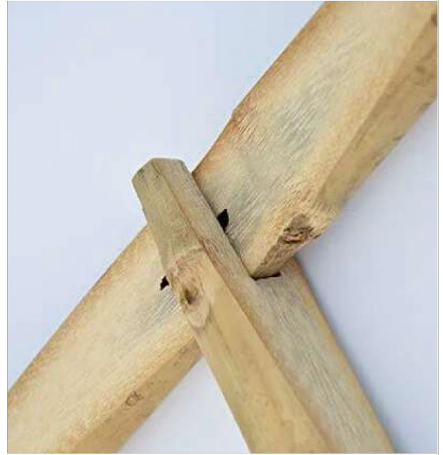
Abbildung 18: Verbindung aus gefrästen Bambus-Bauteilen
