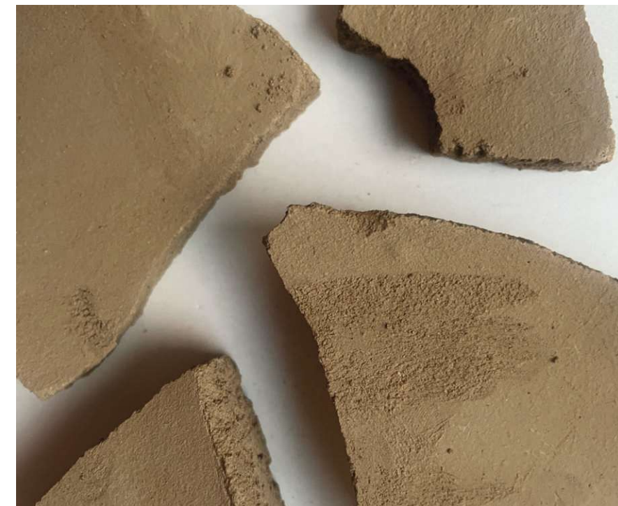
Abb. 14 - Lehmmischung mit gleich hohen Anteil von Lehm und Sand
