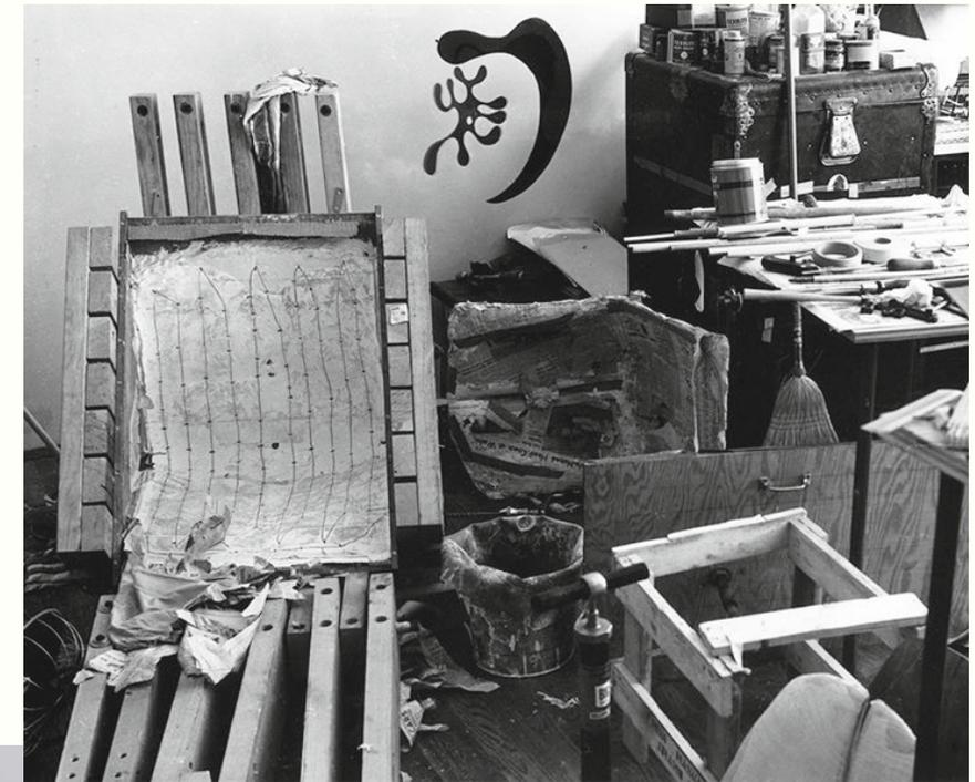
Abb.77: Die Kazam! Maschine zur Produktion von formgepressten Schichtholz
