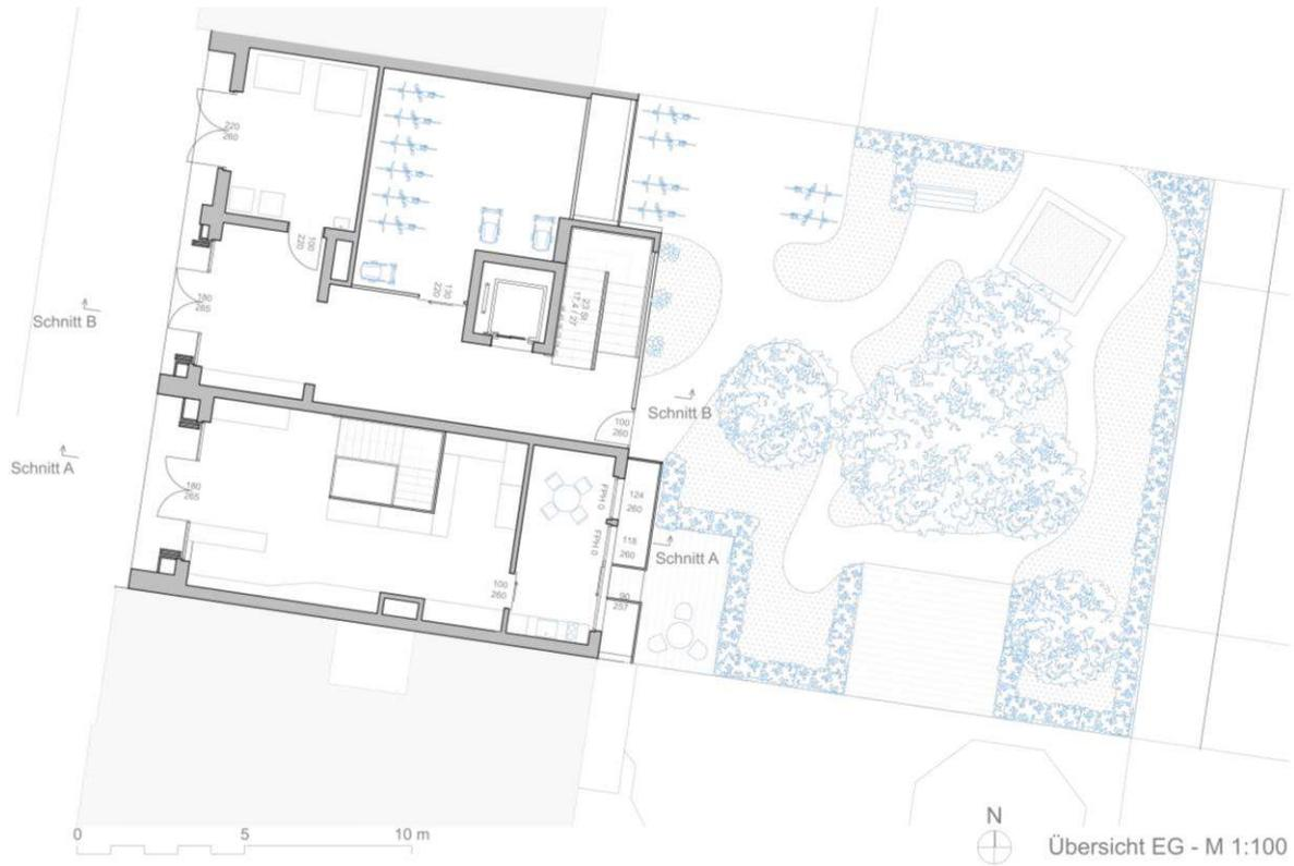
Abbildung 79 Übersicht Erdgeschoß (Quelle eigene Darstellung)
