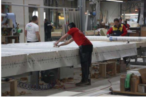
Abbildung 3 manuelle Befestigung der Dampfsperre (Quelle: eigene Aufnahme)
