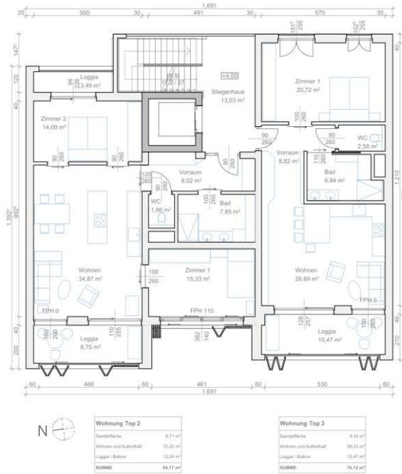
Abbildung 80 Grundriss 1. Obergeschoß (Quelle eigene Darstellung)
