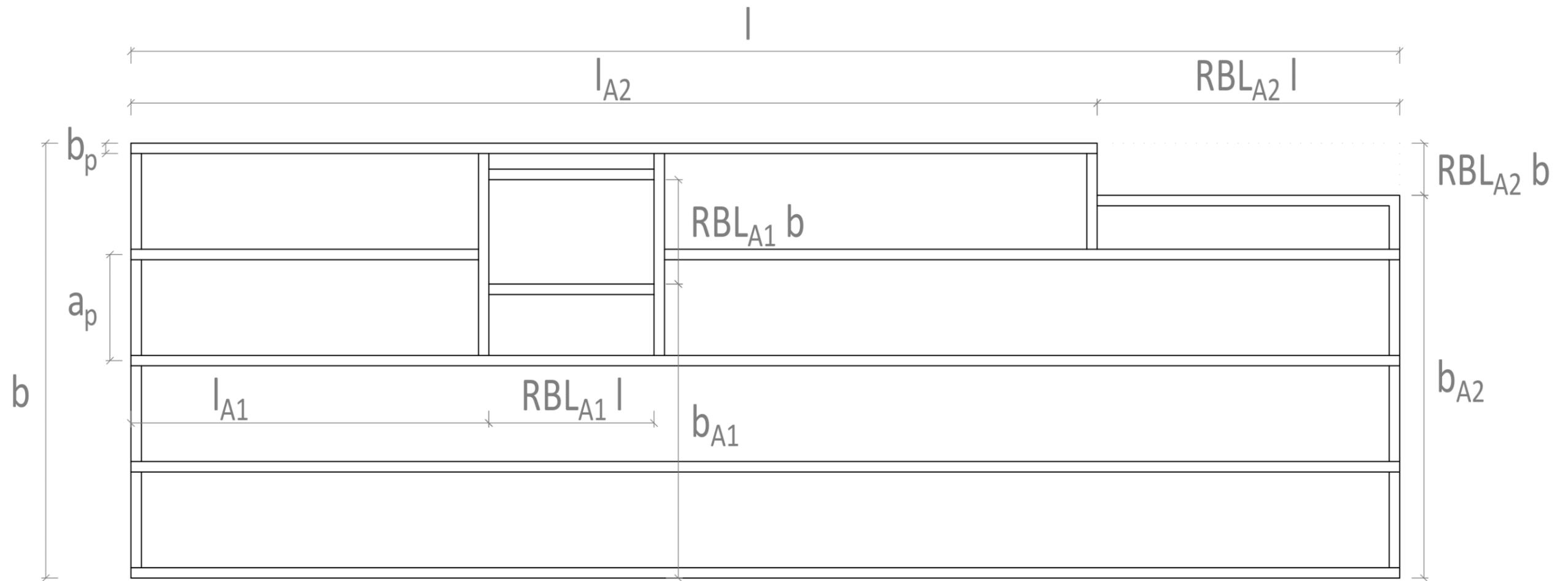
Parameter Bauteilbeschreibung und Bauteilöffnungen Decken M1:25
