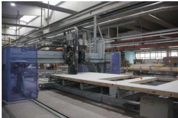
Abbildung 4 CNC-Fräse (Quelle: eigene Aufnahme)
