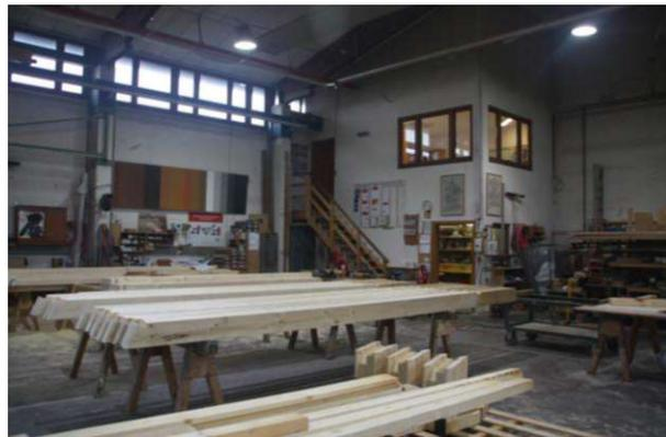
Abbildung 12 zugeschnittene Dachsparren (Quelle: eigene Aufnahme)
