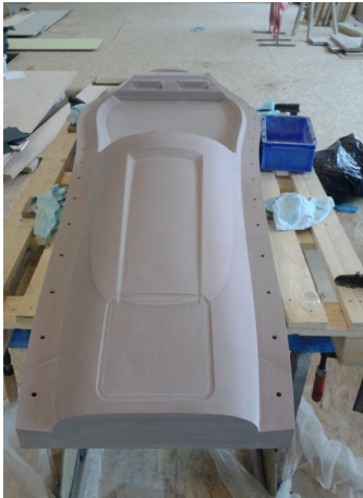
Abbildung 7-5: obere Positivform nach dem Fräsprozess
