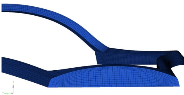
Abbildung 6-5: Diskretisierung des RHCKerns, Detailansicht
