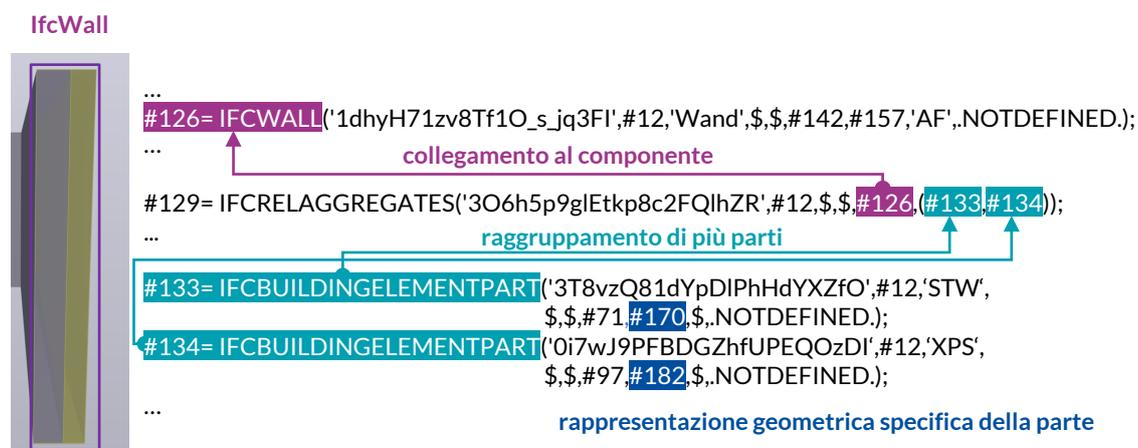
Figura 3.21: Struttura di un IfcWall con IfcBuildingElementPart in formato STEP
