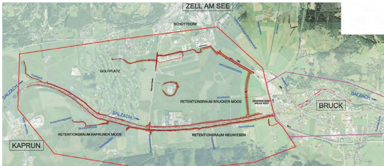
Abb.47 Übersicht Hochwasserschutzmaßnahmen Zeller Becken. Quelle: Sagis 2024.
