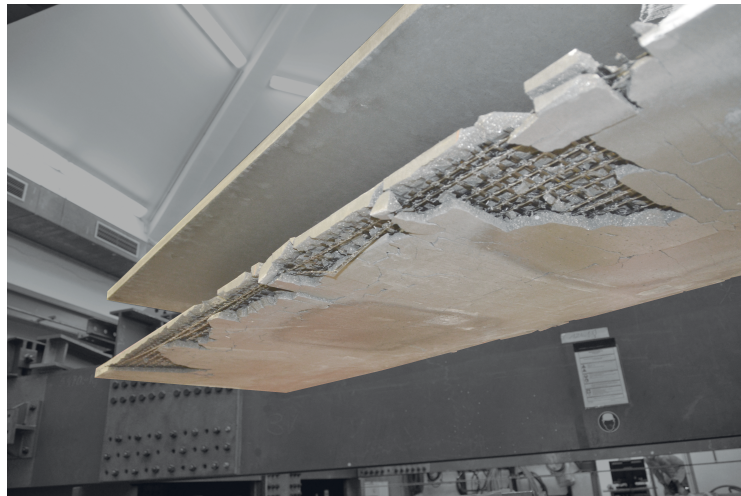
(b) Spaltrissbildung während eines Biegeversuches
