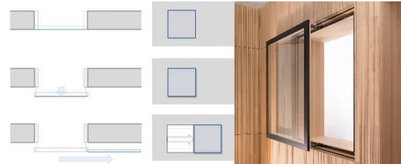
Abbildung 8: Prinzipieller Bewegungsablauf von Prototyp D bzw. dem MOVISTA Fenster (l. Abb: AutorInnen); MOVISTA-Mock-Up wie auf der Bau 2023 gezeigt (r., Image Source: KDM-INNO.com)
