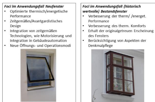
Abbildung 2: Unterschiede zwischen den F&E-Ansätzen für neue und bestehende Fensterkonstruktionen (eigene Abbildung AutorInnen)
