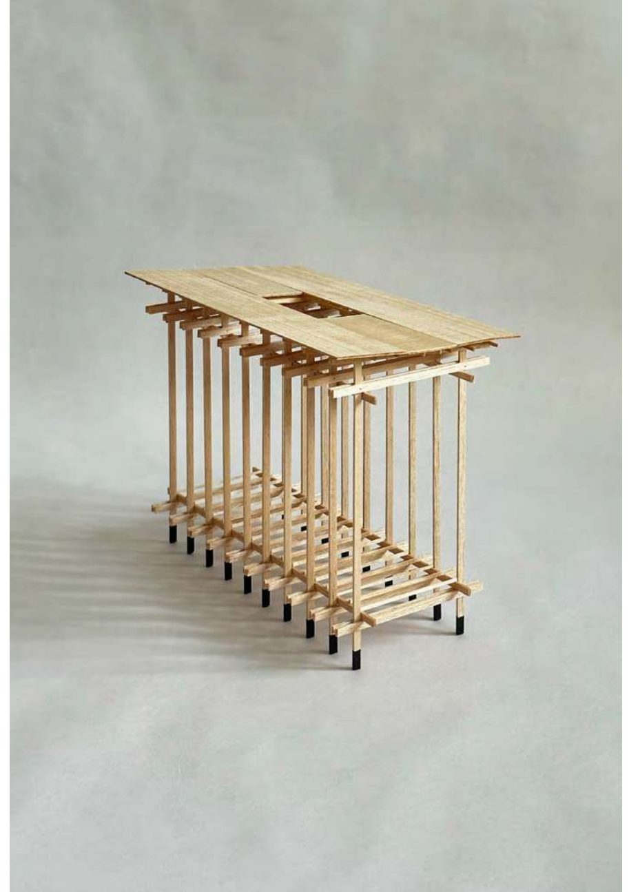
Strukturmodell im Maßstab 1.50, Holzstäbe und -furnier, Acrylfarbe
