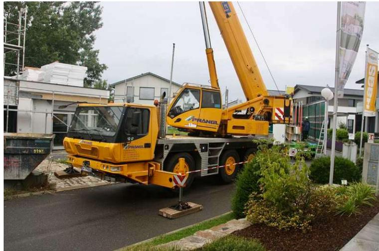
Abbildung 28 Aufstellen des Krans (eigene Abbildung)
