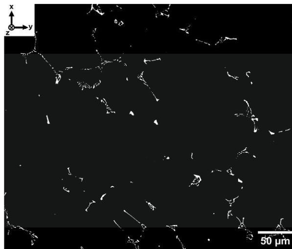
Abbildung 72: Ausschnitte der Fe A-BSE-Aufnahmen der Probe 1s-1\_550C\_20mm an der Probenoberseite, in halber Probenhöhe und an der Probenunterseite
