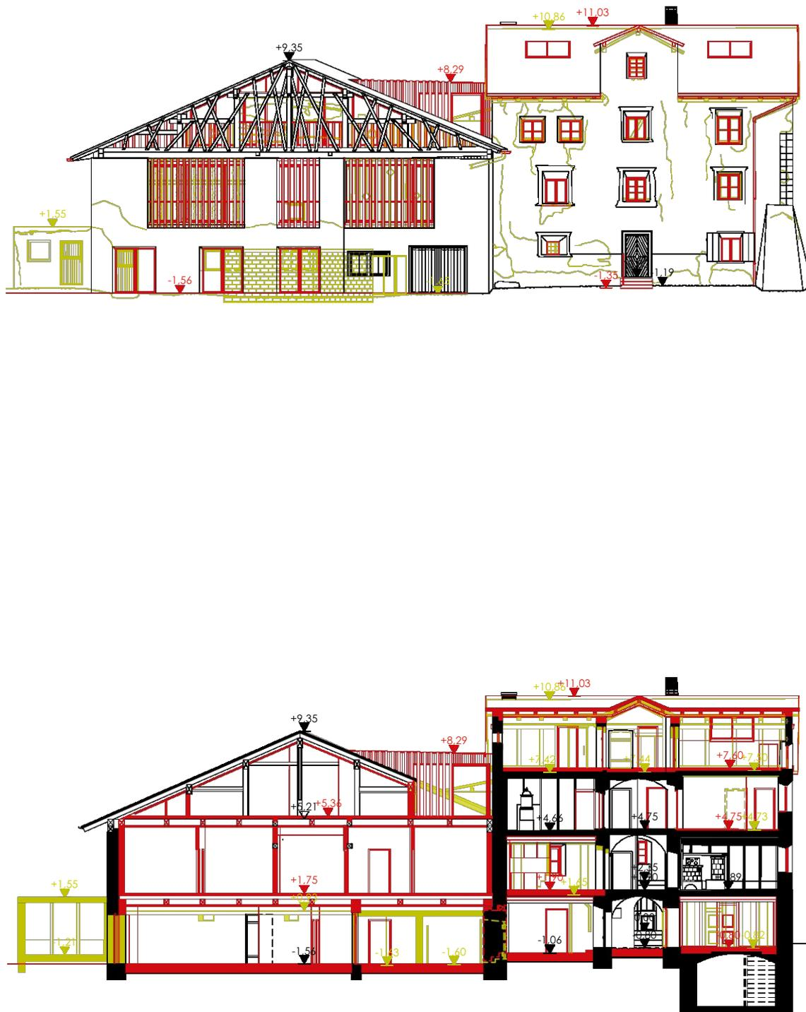
Abb. 167: Umbaupläne Südansicht/Längsschnitt M 1:250
