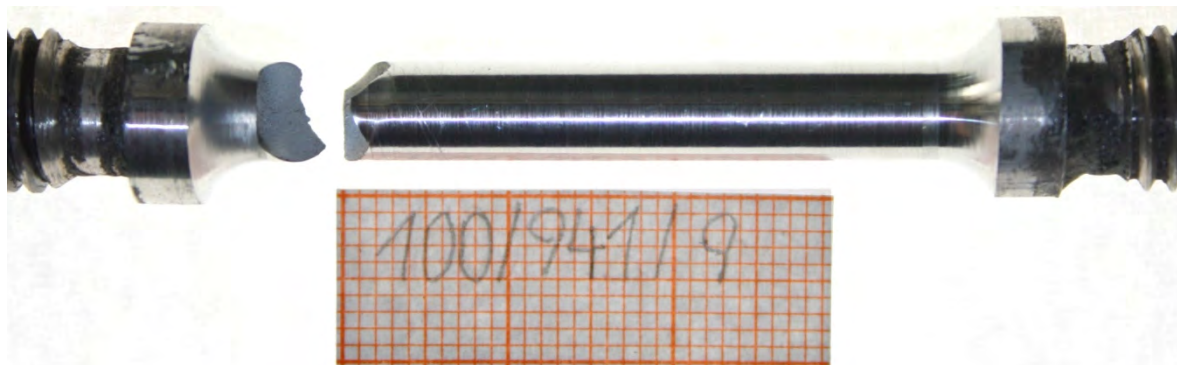
Abbildung 56: A27A extrudiert bei 100MPa (Nr. 2) und 300°C, gebrochen nach 7.896 h
