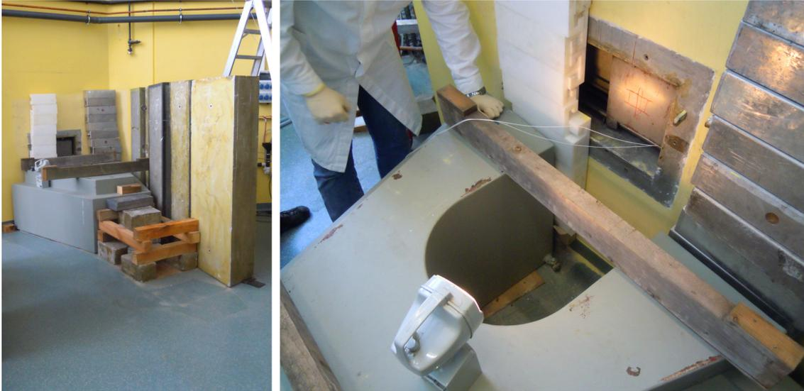
Abbildung 1.3: (*Links*) Bild des Strahlrohrs mit geöffneter Abschirmung. Die einzelnen Betonelemente sind gut sichtbar. (*Rechts*) direkt vor dem, mit dem manuellen Bleishutter verschlossenen, Strahlrohr. Der gräuliche Körper mit der U-förmigen Ausnehmung, auf dem die Lampe und die Holzscheite liegen, ist der unterste Teil des Borsäuretanks auf den zwei weitere Elemente aufgesetzt werden können.
