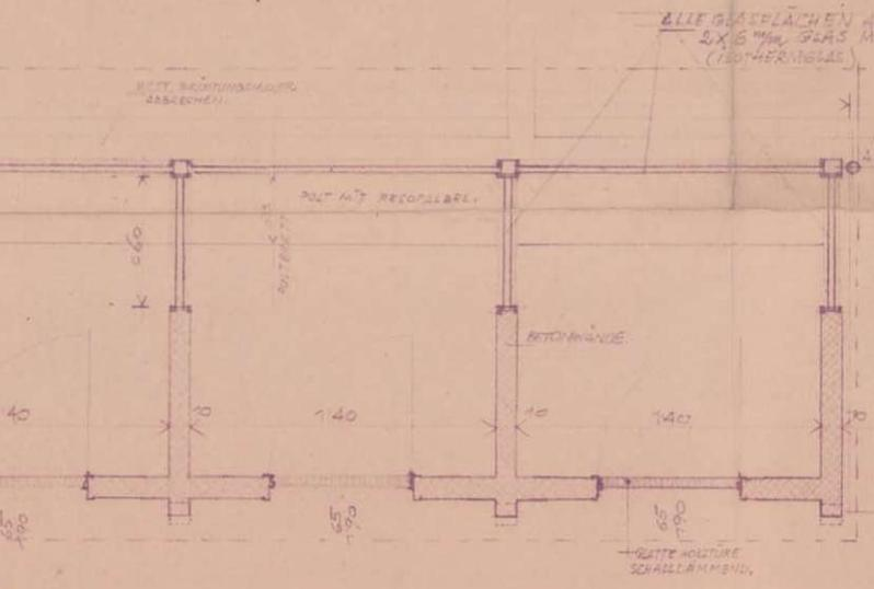
ALLE METALLTEILE AUS ALUMINIUM ELOXIERT AUSFÜHREN!
