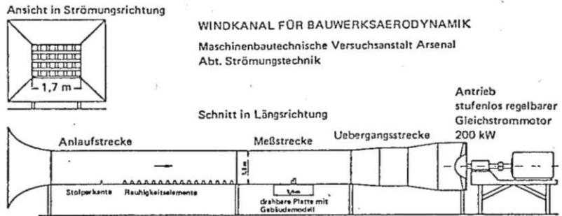
Bild 5 : Windkanal für Bauwerksaerodynamik
