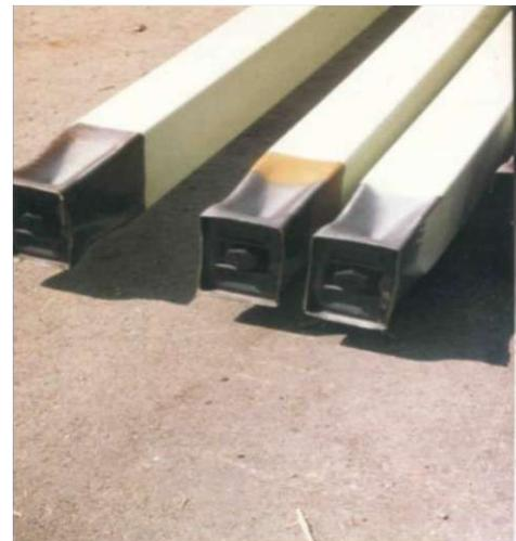
Abbildung 1-4: Funktionsweise des CONZEM Fachwerkknoten, deformierte Stabenden
