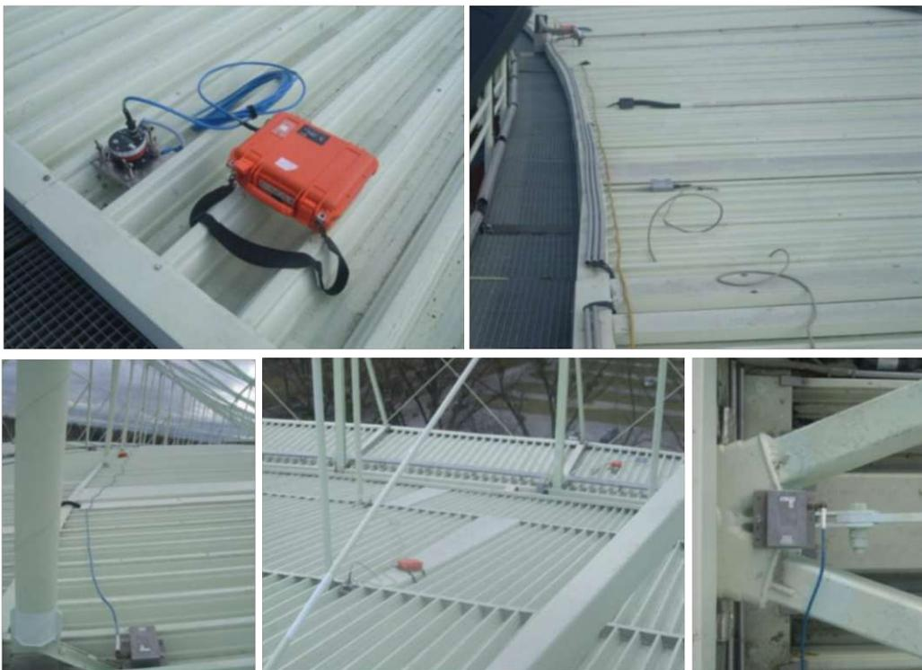
**Bild 6:** Dokumentation der BRIMOS® Basismessung
