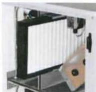
Leicht wechselbare Kassettenfilter
