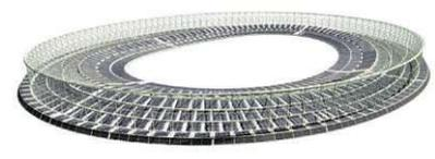
Visualisierung - Dach Bestand mit PV Anlage Neu
