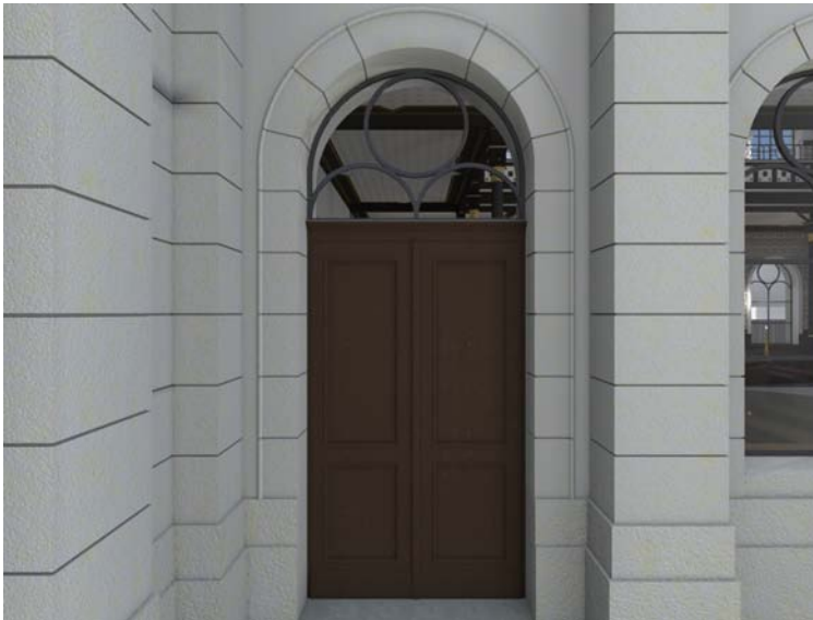
Abb.55: Rekonstruktion der Tür zur Gebetshalle, Rendering ( Artlantis )
