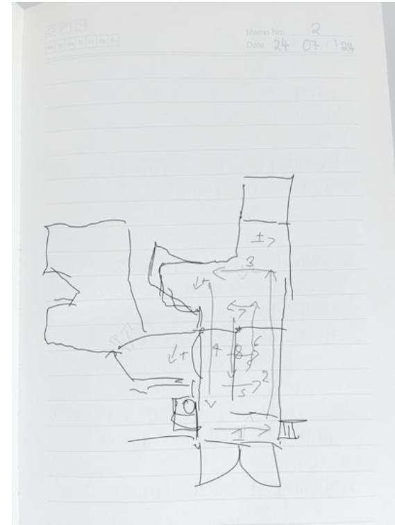
**Abb. 3:** Handskizzierter Plan eines Kellers mit dem geplanten Ablauf des photogrammetrischen Scans.
