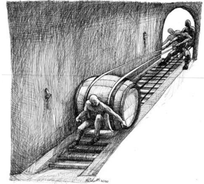
Abb. 54: Das Transportsystem der Weinfässer in Cantine.
