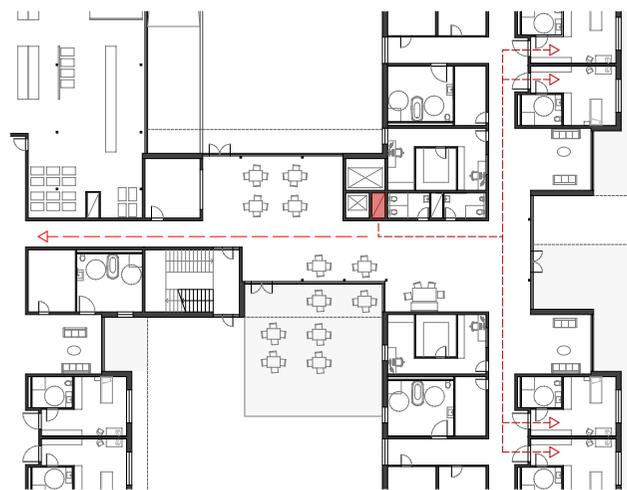
Abbildung 92 - Planauszug KG/EG, Anlieferung/ Versorgung MED-Gase
