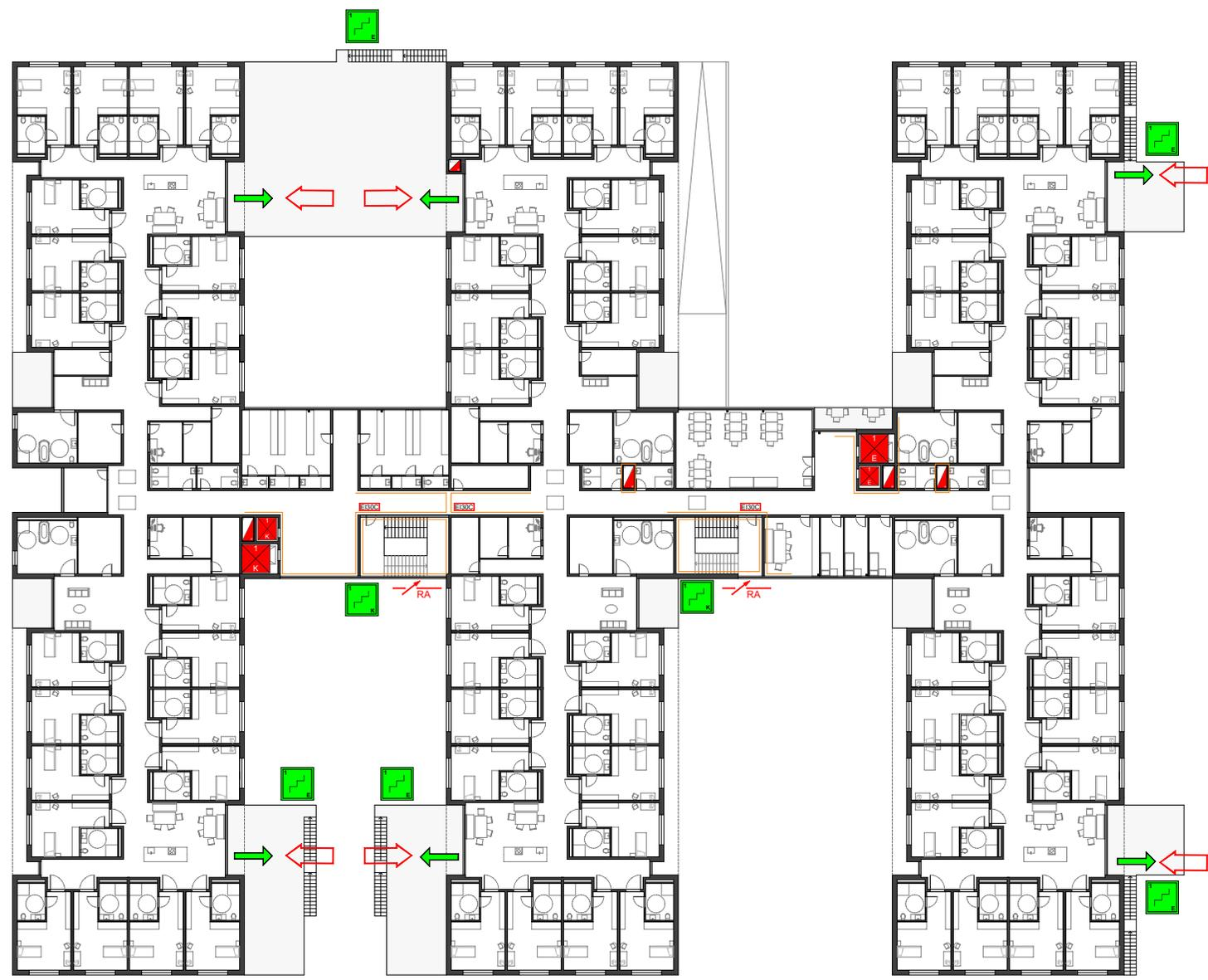
Abbildung 78 - Brandschutzplan Grundriss OG
