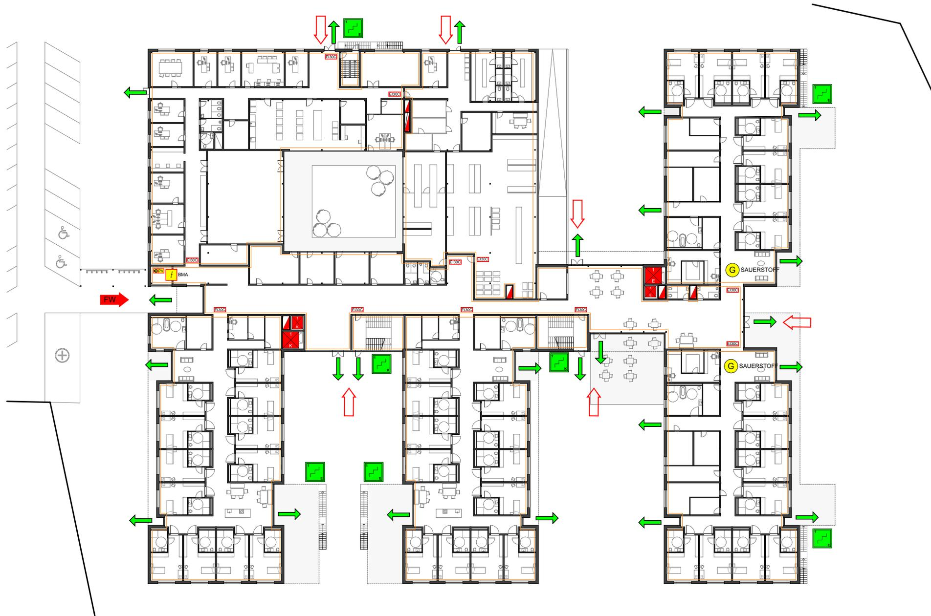
Abbildung 77 - Brandschutzplan Grundriss EG
