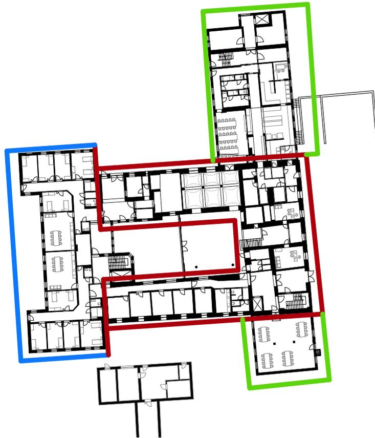
Abbildung 8 - Grundriss EG LPBZ Christkindl; Rot-Umriss ursprüngliches Hofgebäude, Blau – Zubau 1963, Grün – Erweiterung 2004
