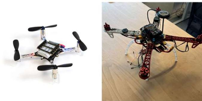
Abbildung 26: Darstellung der Drohnen Bitcraze Crazyflie 2.1<sup>159</sup> und DIY-Variante<sup>160</sup>
