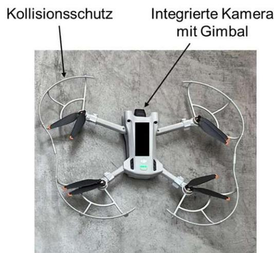
Abbildung 34: Eingesetzte DJI Mini 3 Pro für die Datenaufnahme inklusive Kollisionsschutz<sup>226</sup>
