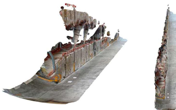
**Abbildung 40: Digitales Modell auf Basis von Bildaufnahmen mit einem Kamerawinkel von 0°<sup>233</sup>**
