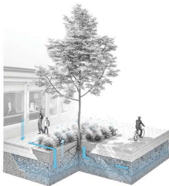
Abb. 46 - Schema Schwammstadt, Rendering von 3:0Landschaftsarchitekten, https://www.schwammstadt.at/
