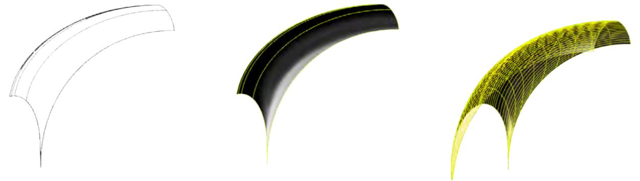
Abb. 127: Gewölbemodellierung mittels Rhino-Flächenwerkzeug Schritt 1,2,3
