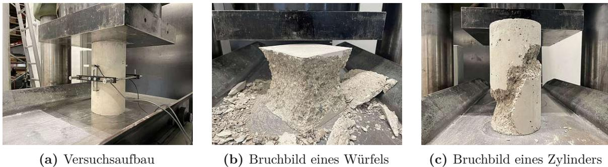
**Abb. 3.11:** Versuche zur Bestimmung des E-Moduls und der Druckfestigkeit
