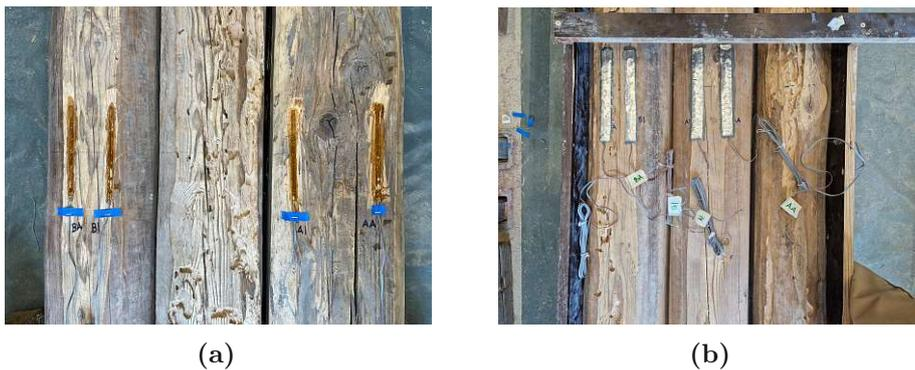
**Abb. 3.5:** DMS auf den Dippelbäumen für die (a) STB- und (b) TXB-Verbunddecke
