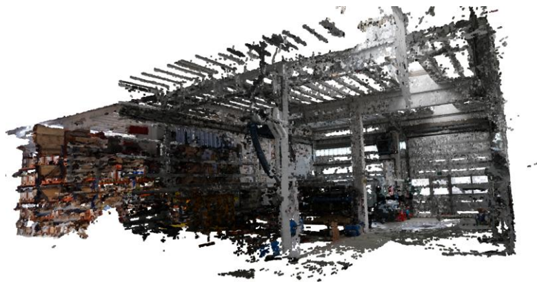
Abbildung 3.1: Punktwolke des Use Case A mit erkennbarer Stützen-Träger Tragwerksstruktur
