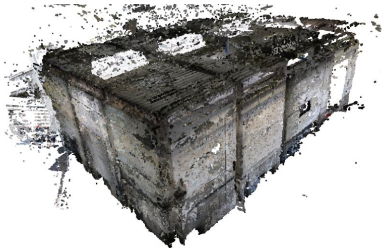
Abbildung 5.7: Punktwolke aus dem Gebäudescan für USE Case B
