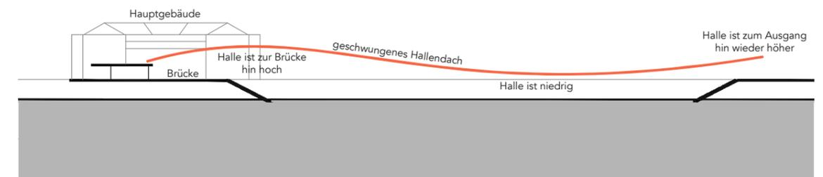
Abb. 69: Dach als Richtungsweiser - Schnitt
