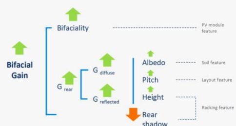
Abbildung 11: Solarstromertrag bifacialer Solarmodule, zusammengesetzt aus frontseitigem und rückseitigem Solarstromertrag. Quelle: Präsentation Trina Solar 11
