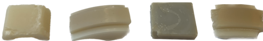
Abbildung 34: Dental Blank Rückstände mit Störstoffen bei 1450 °C gesintert (Vorversuch 1)
