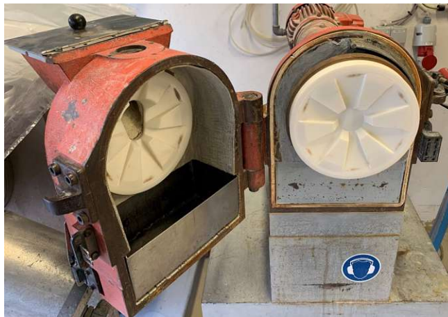
Abbildung 16: Scheibenmühle zur Vorzerkleinerung
