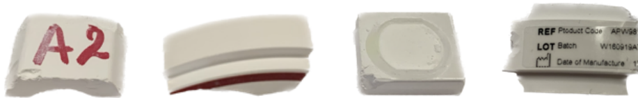
Abbildung 32: Potentielle Störstoffe auf Dental Blank Rückständen (Vorversuch 1)
