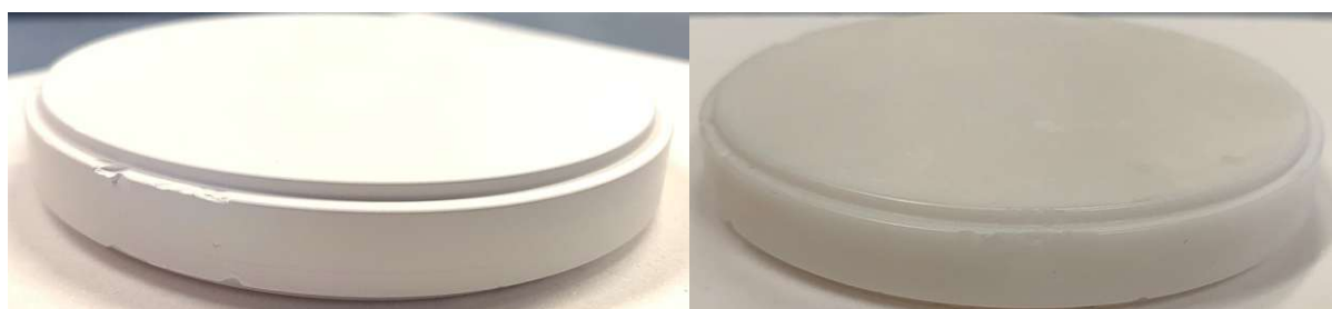
Abbildung 39: Dental Blank 4Y (Weiß) bei 850 °C behandelt (links) und bei 1450 °C gesintert (rechts)
