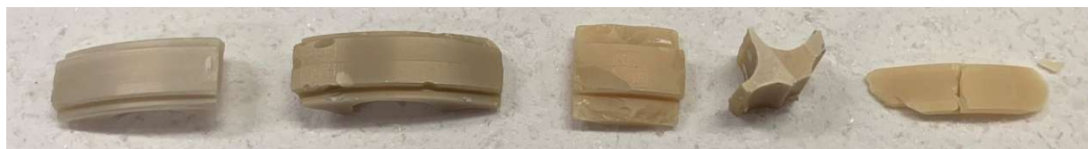
Abbildung 37: Dental Blank Rückstände mit Störstoffen bei 1450 °C gesintert (Vorversuch 2)
