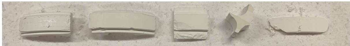
Abbildung 36: Dental Blank Rückstände mit Störstoffen bei 850 °C behandelt (Vorversuch 2)
