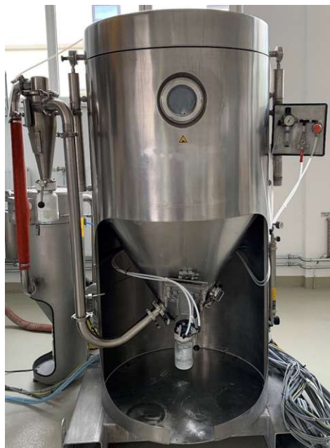
Abbildung 19: Sprühtrockenturm Mobile Minor
