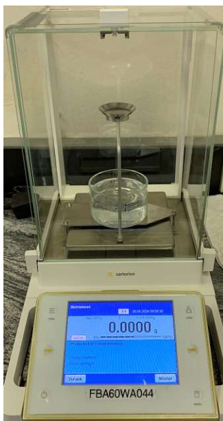
Abbildung 28: Analysenwaage inklusive archimedischem Aufbau
