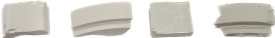
Abbildung 33: Dental Blank Rückstände mit Störstoffen bei 850 °C behandelt (Vorversuch 1)
