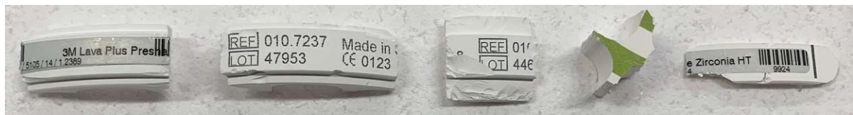
Abbildung 14: Potentielle Störstoffe auf Dental Blank Rückständen (Vorversuch 2)
