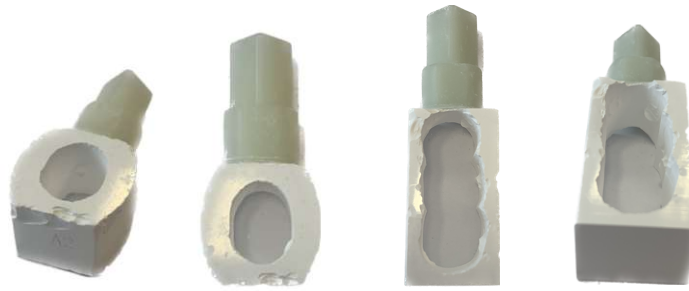
Abbildung 11: Beispiele von Blöcken zur Herstellung von Einzelkronen oder dreigliedrigen Brücken
