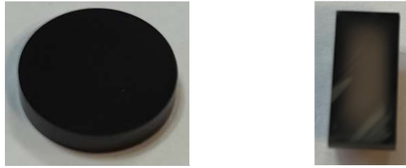
Abbildung 68: Dotiertes und gefärbtes Recycling-3Y-25A-S (ganze Prüftablette links, geschnitten rechts)
