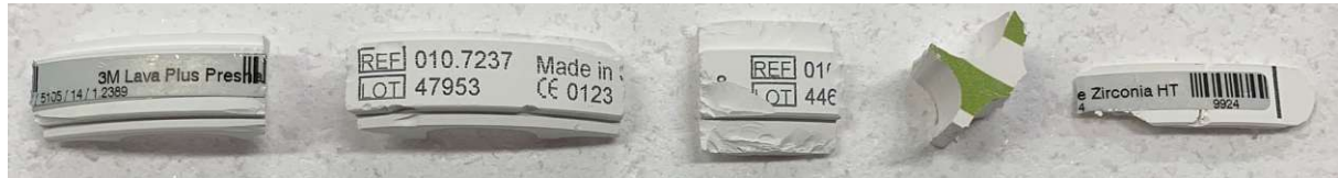
Abbildung 35: Potentielle Störstoffe auf Dental Blank Rückständen (Vorversuch 2)
