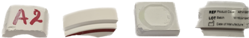
Abbildung 13: Potentielle Störstoffe auf Dental Blank Rückständen (Vorversuch 1)
