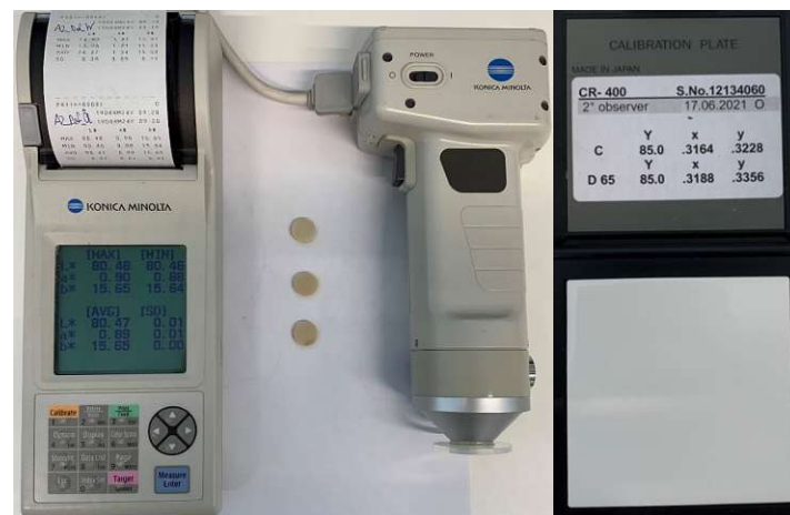
Abbildung 29: Chromatometer CR-400 zur Farbmessung inklusive Referenzfarbe
