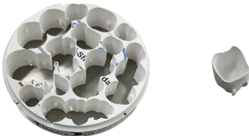
Abbildung 69: Beispiel eines fertig ausgefrästen Dental Blanks (links) und einer Einzelkrone (rechts)
