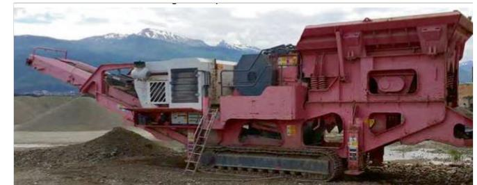
Abb.61 Zerkleinerung des Schuttes in mehreren Phasen über Betonbrecher
