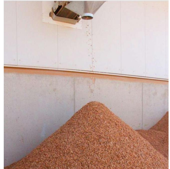
Abb.56 Aufbereitung von Ziegelbruch zu Sekundärbaustoffen
