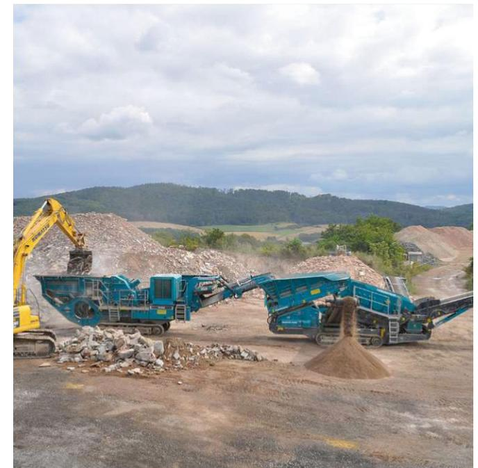
Abb.33 Betoncrushers - Wiederverwertung des Bauschuttes, bereinigung durch Windsichter
