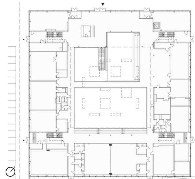
Abb. 5 Grundriss, Erdgeschoss, Anordnung der Klassenräume um das Raumvolumen der Sportanlage
