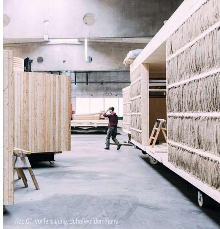
Abb.67: Vorfertigung, Schafwolldämmung
