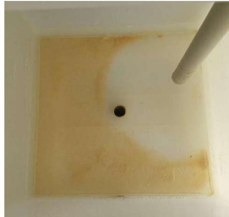
Abbildung 26: Ablagerung des Elektrolyts im internen Tank (E2) der ED2
