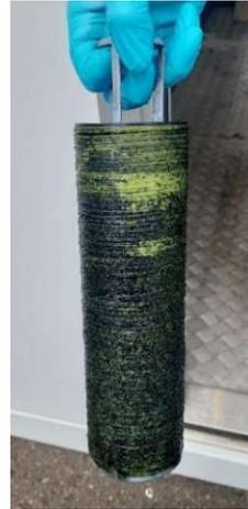
Abbildung 15: verschmutzter Scheibenfilter
