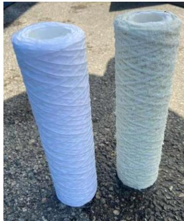
Abbildung 39: Kartuschenfilter in ED (links sauber, rechts mit Ablagerung/ schmutzig)
