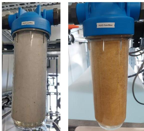
Abbildung 22: Kerzenfilter / Polizeifilter: sauber (li), verschmutzt (re)
