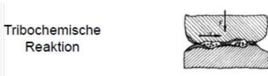
Abbildung 9: Schematische Darstellung einer tribochemischen Reaktion in tribologischen Systemen. Durch mechanische Belastung und die dabei entstehende Reibungswärme kommt es zu chemischen Reaktionen an der Kontaktoberfläche. Diese Reaktionen führen zur Bildung einer schützenden Reaktionsschicht, die Reibung und Verschleiß reduziert und zur Selbstheilung der Oberfläche beiträgt. (LVA Festschmierstoffe Vorlesungsfolien, Gachot 2023)
