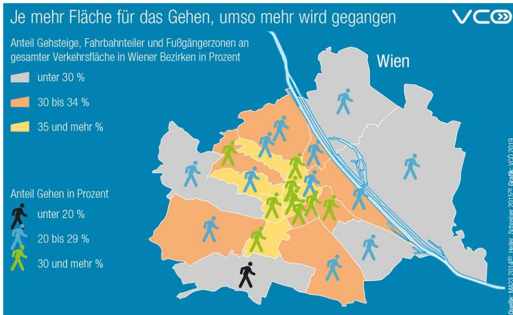
**Abbildung 5:** Gegenüberstellung der Fläche von Fußwegen, Fußgängerzonen und Fahrbahnteilern mit dem Fußwegeanteil am Modal Split (Heller et al., 2019)
