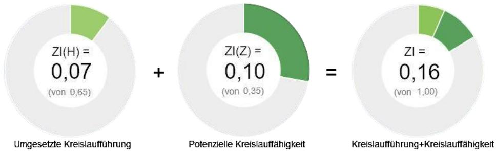
Abb. 7.24: Fallbeispiel DGNB-ZI – Rechenbeispiel Trockenbauwand IW07 - Ergebnis des DGNB-ZI (eigene Darstellung)
