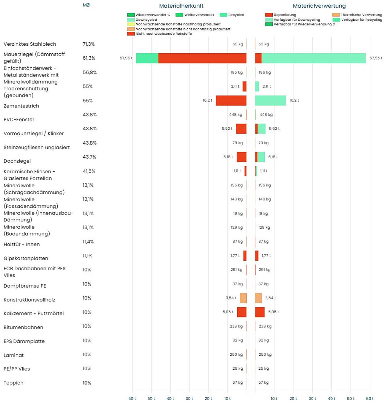
Abb. 7.16: Fallbeispiel Madaster MZI – Materialstrom eingesetzter Materialien/Produkte (Madaster Foundation GmbH, o.D.)
