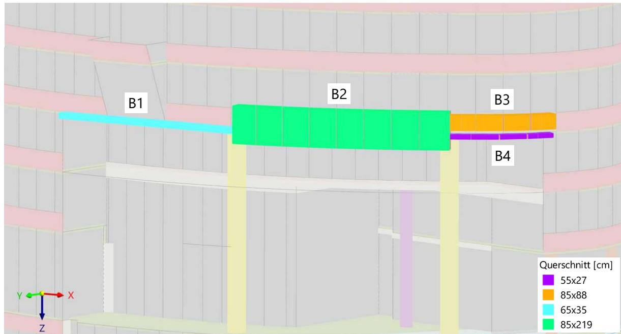
Abb. 4.22: Balken in Decke über E+2, Übersicht zu bemessender Stäbe
