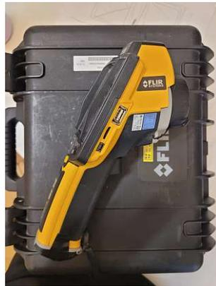
**Abb. 6.29:** verwendetes Messgerät für Thermographie [eigene Aufnahme]
