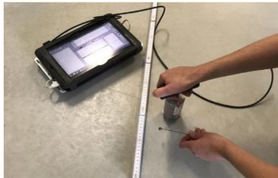
Abb. 4.14: Darstellung der Impakt-Echo Prüfung [55]
