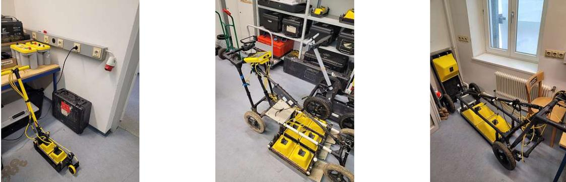
Abb. 6.9: GPRs mit unterschiedlichen Frequenzen [eigene Aufnahmen]
