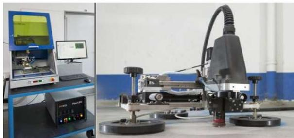
Abb. 4.41: Darstellung LASER-induzierte Plasmaspektroskopie (LIPS) [55]
