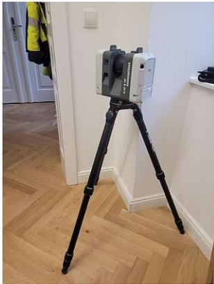
**Abb. 6.2:** terrestrischer Laserscanner [eigene Aufnahme]
