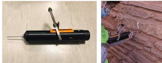
Abb. 4.2: Darstellung Penetrometerprüfung [12]
