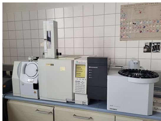
**Abb. 6.15:** GCMS Gerät [eigene Aufnahme]
