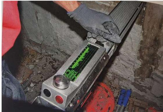
Abb. 4.6: Darstellung Bohrwiderstandsprüfung [23]
