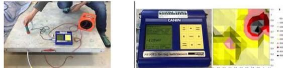
Abb. 4.40: Darstellung der Potentialmessung [55]
