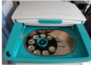
Abb. 4.42: Darstellung Röntgenfluoreszenzanalyse Gerät [55]
