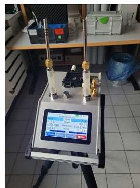
**Abb. 6.12:** Gerät für Luftprobenentnahme [eigene Aufnahmen]
