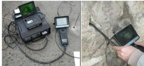
**Abb. 4.27:** Darstellung eines Videoskop [55]
