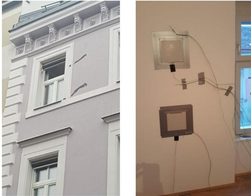
**Abb. 6.18:** Versuchsaufbau HFM [31]
