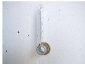
Abb. 4.38: Darstellung des Karsten'schen Wasserprüfröhrchen [54]
