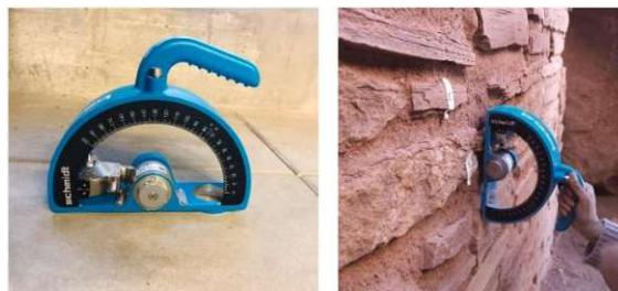
Abb. 4.4: Darstellung Pendelrückprallhammer [12]
