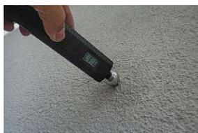
**Abb. 4.39:** Darstellung der elektrischen Feuchtigkeitsmessung [23]
