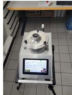
Abb. 6.13: Gerät für Schimmelpollenentnahme [eigene Aufnahmen]
