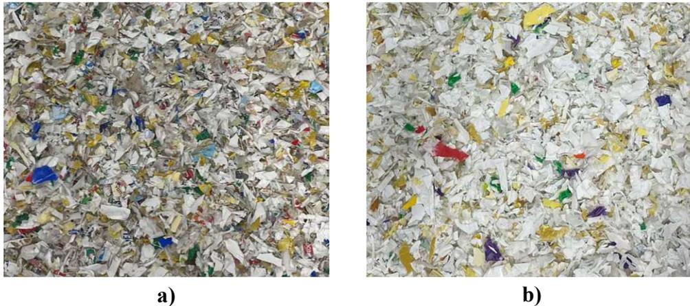
Abbildung 42: PP Flakes spritzgegossen nach Schwimm-Sink: a) 80 °C H<sub>2</sub>O, b) 80 °C NaOH
