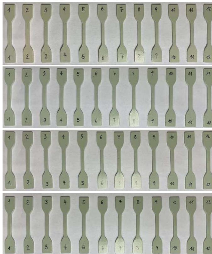
**Abbildung 72:** Zugstäbe PP tiefgezogen 80 °C NaOH; von oben nach unten 0x, 1x, 3x und 5x extrudiert
