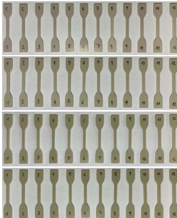
**Abbildung 76:** Zugstäbe PP spritzgegossen 80 °C NaOH; von oben nach unten 0x, 1x, 3x und 5x extrudiert
