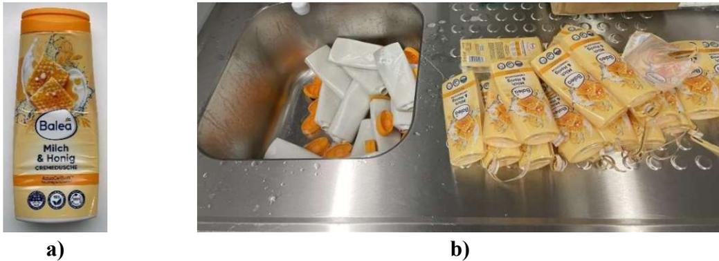
**Abbildung 79:** a) Ausgangsmaterial (komplette Post-Consumer Duschgelflasche), b) Prozess der Aufbereitung des Ausgangsmaterials
