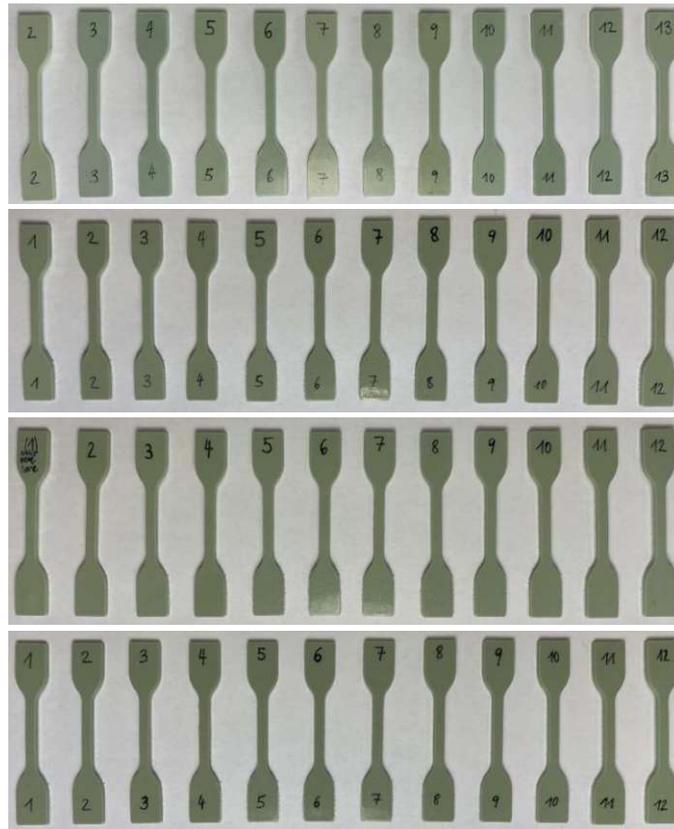
**Abbildung 75:** Zugstäbe PP spritzgegossen 60 °C NaOH; von oben nach unten 0x, 1x, 3x und 5x extrudiert
