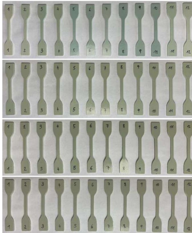
**Abbildung 71:** Zugstäbe PP tiefgezogen 60 °C NaOH; von oben nach unten 0x, 1x, 3x und 5x extrudiert
