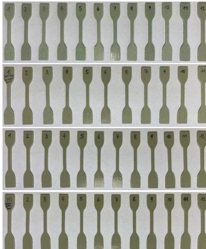
**Abbildung 74:** Zugstäbe PP spritzgegossen 80 °C H<sub>2</sub>O; von oben nach unten 0x, 1x, 3x und 5x extrudiert
