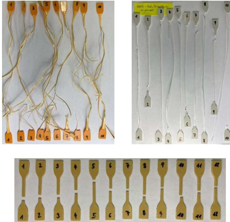
**Abbildung 82:** Zugstäbe PP, HDPE und Mischung HDPE+PP (1x extrudiert, nach Prüfung)
