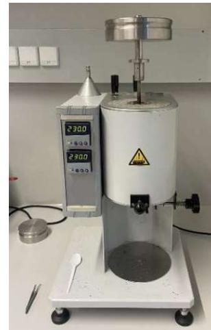
**Abbildung 36:** Verwendetes Schmelzindex-Prüfgerät
