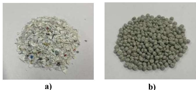
**Abbildung 20:** PS (Viscotec): a) PS Flakes, b) PS Regranulat
