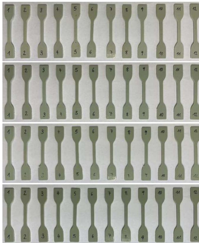
**Abbildung 70:** Zugstäbe PP tiefgezogen 80 °C H<sub>2</sub>O; von oben nach unten 0x, 1x, 3x und 5x extrudiert
