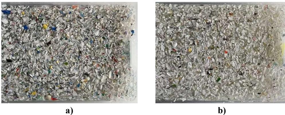
**Abbildung 44:** PS Flakes im Wasserbad (Schwimm-Sink-Verfahren): a) 80 °C H<sub>2</sub>O, b) 80 °C NaOH
