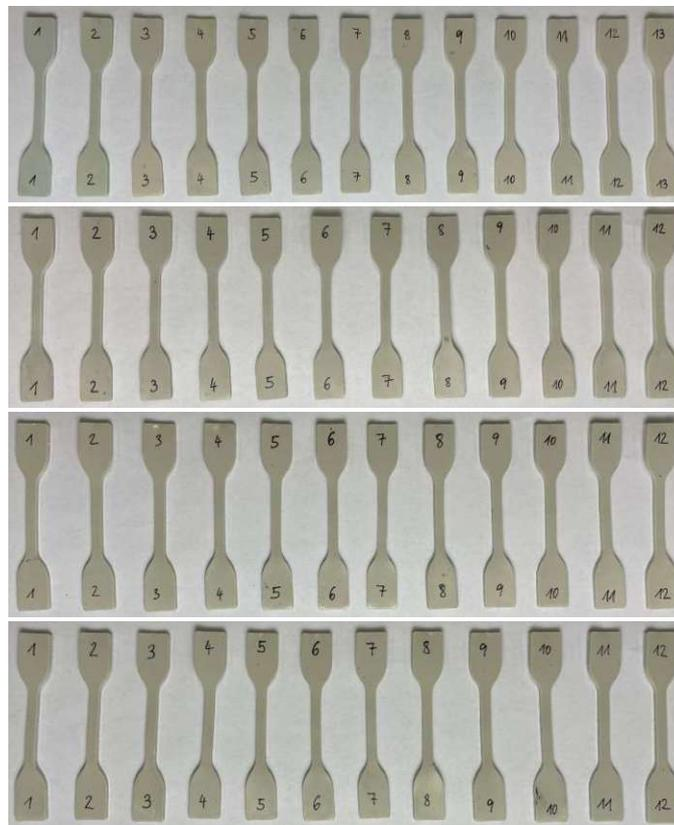
**Abbildung 78:** Zugstäbe PS tiefgezogen 80 °C NaOH; von oben nach unten 0x, 1x, 3x und 5x extrudiert
