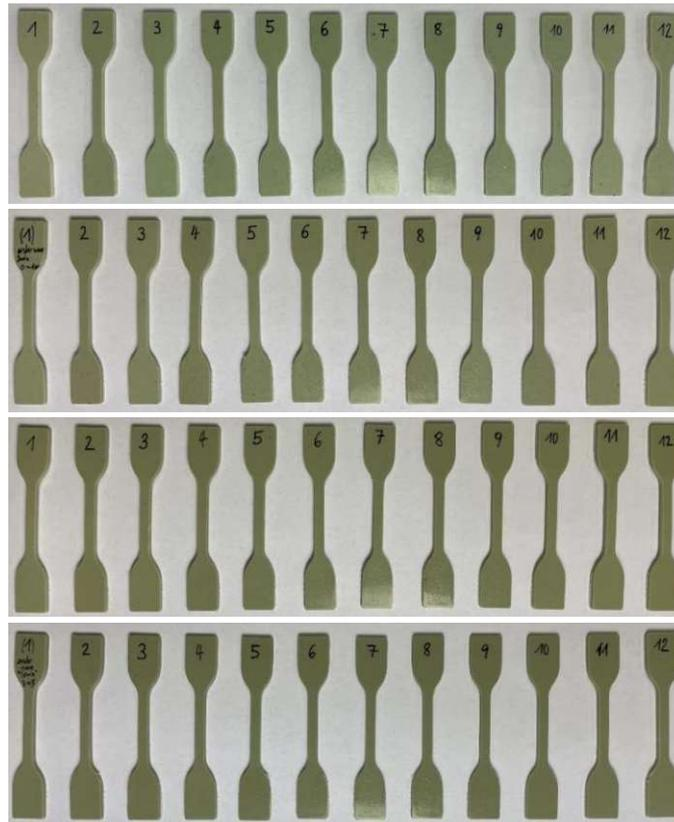
**Abbildung 73:** Zugstäbe PP spritzgegossen 60 °C H<sub>2</sub>O; von oben nach unten 0x, 1x, 3x und 5x extrudiert
