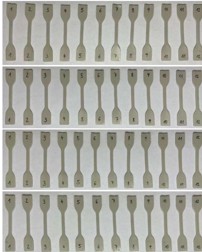
**Abbildung 77:** Zugstäbe PS tiefgezogen 80 °C H<sub>2</sub>O; von oben nach unten 0x, 1x, 3x und 5x extrudiert
