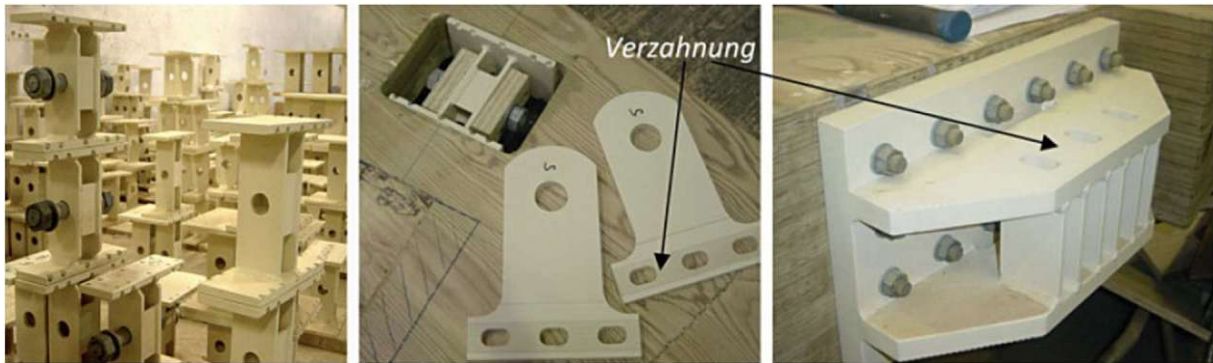
Abb. 50: Verbindungen mit 450 verschiedenen Größen unterteilt in 15 Grundtypen [40]
