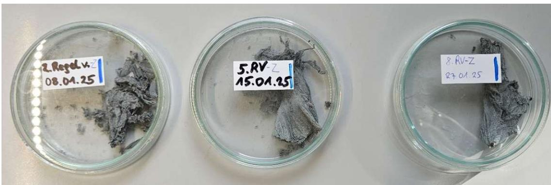
Abb. C. 2: Proben für Voranalyse
