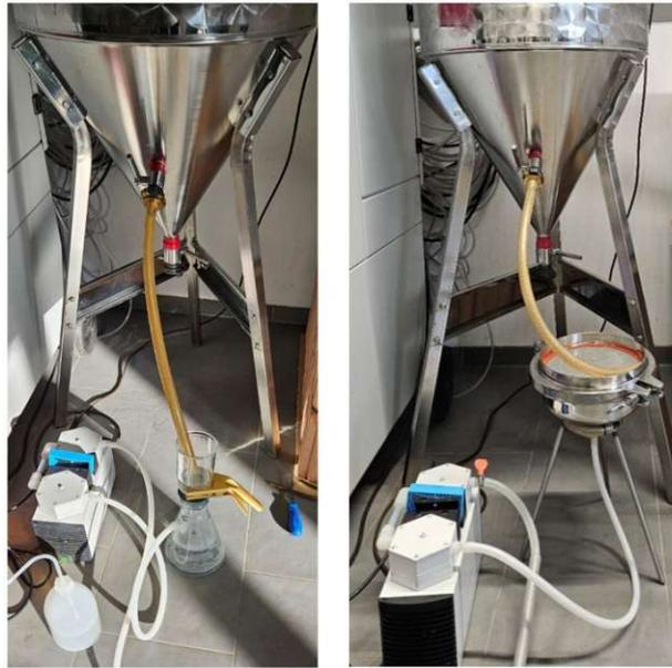
Abb. 3.4: Versuchsaufbau 1. Vorversuch (links Filter 1-6; rechts Filter 7& 8)
