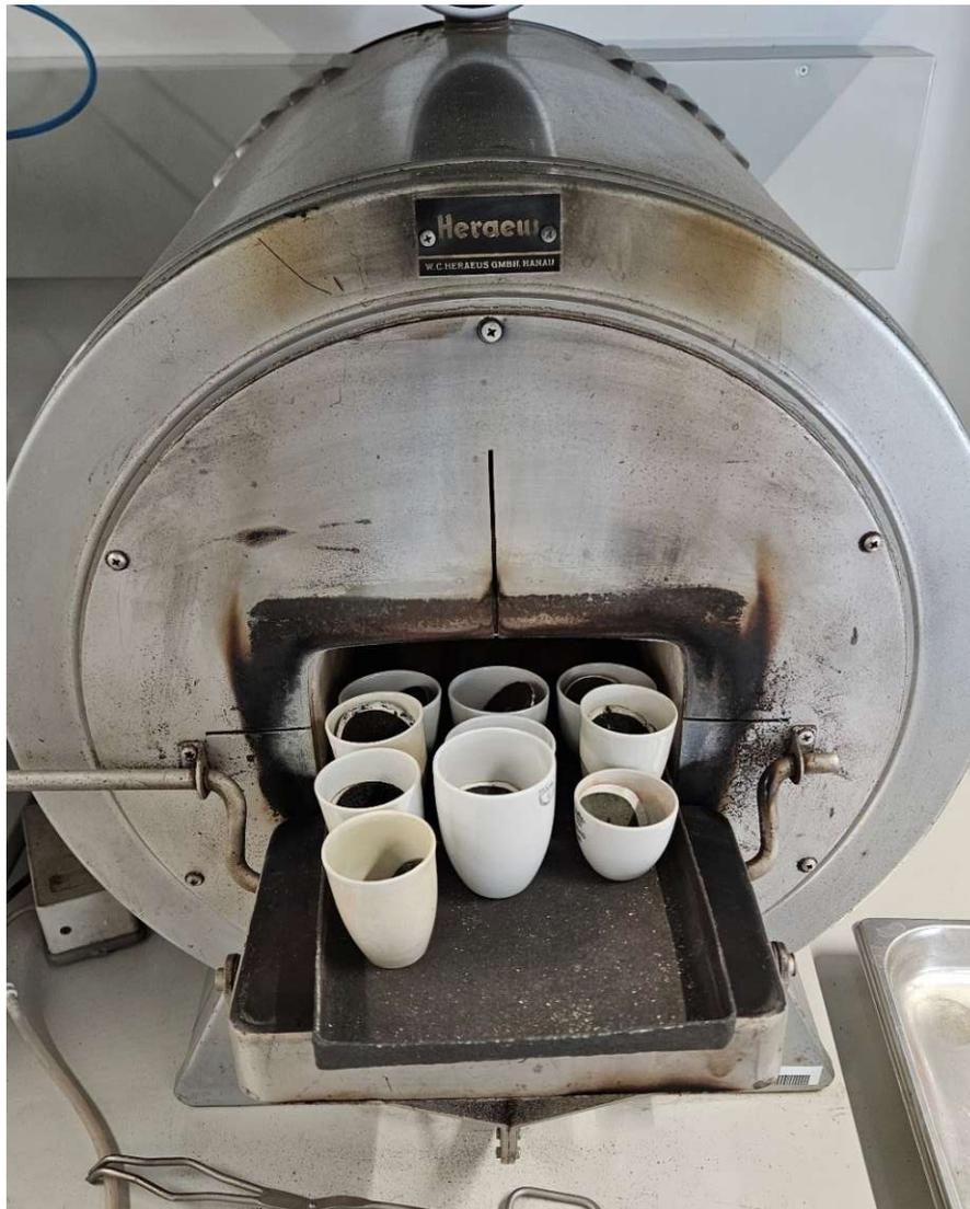
Abb. C. 10: Hauptanalyse: Proben vor der Veraschung
