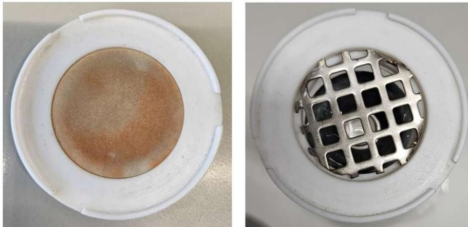
Abb. 3.5: Glasfritte (links), neue Unterkonstruktion (rechts)
