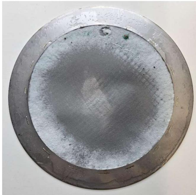
Abb. 3.17: Filter nach Kontrollversuch (keine Textilien, nur Pulverwaschmittel)
