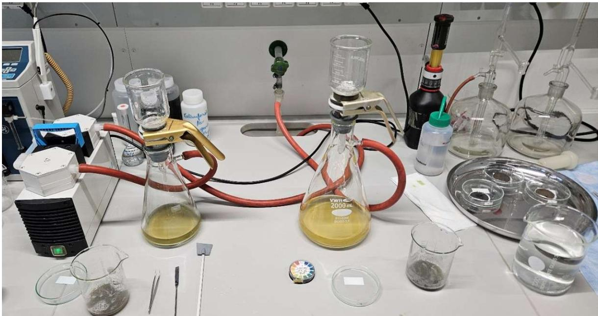
Abb. C. 6: Hauptanalyse: Filtration der Proben während SDM
