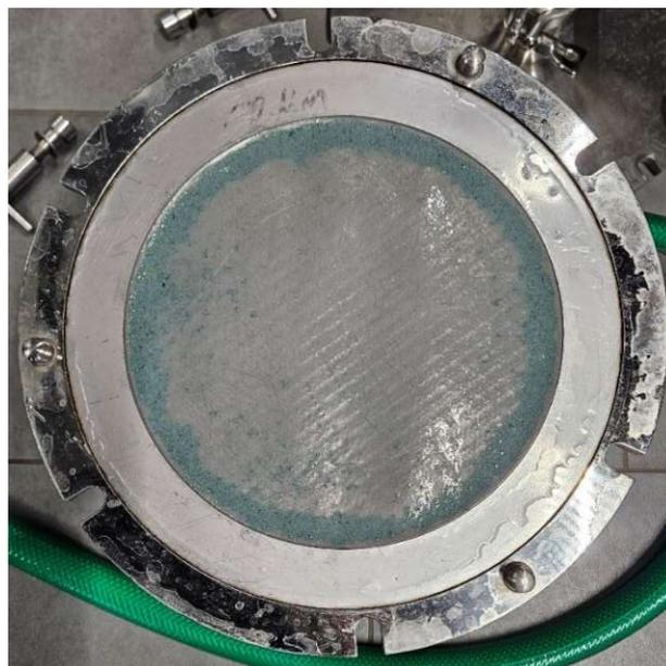
Abb. 3.15: Verstopfter Filter durch Waschmittellösung
