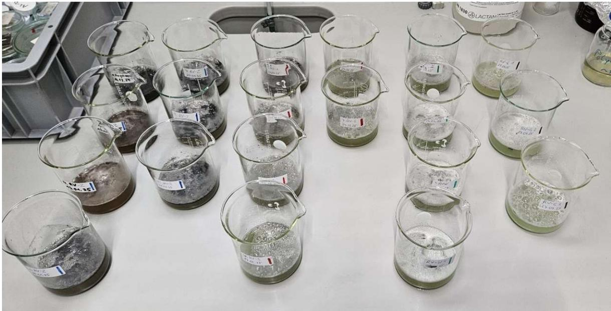
Abb. C. 5: Hauptanalyse: Selektive Auflösung der Proben während SDM
