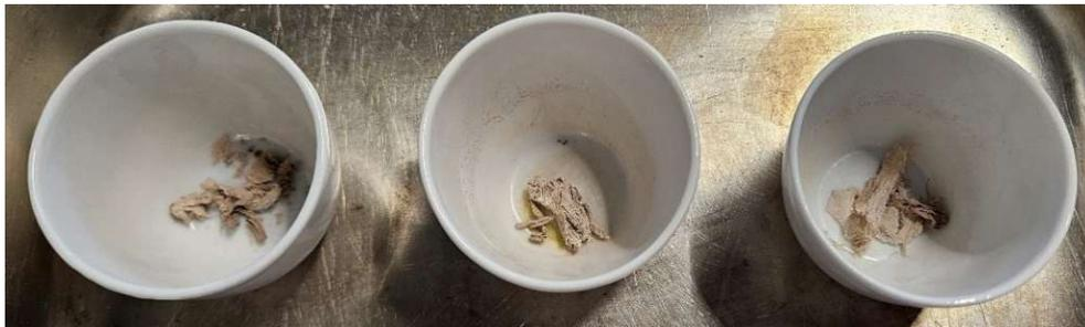
Abb. 4.4: Prüfmenge A nach der Veraschung
