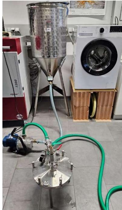
Abb. 3.6: Umstieg auf Druckfiltration
