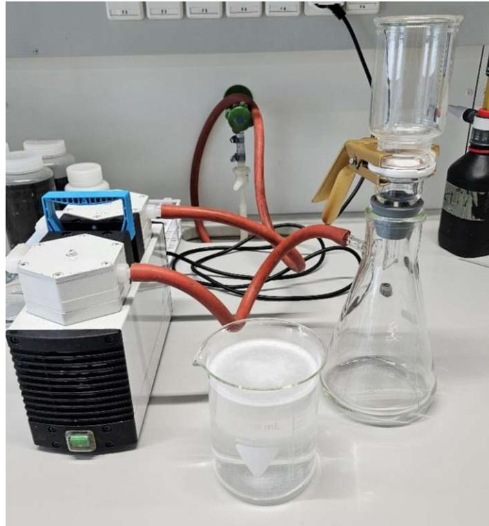
Abb. 3.8: Versuchsaufbau Filtrierbarkeit Waschmittellösung
