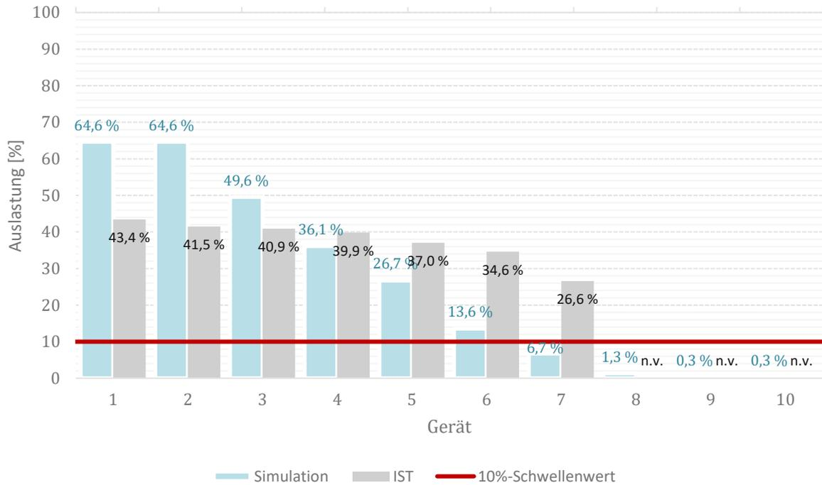
Abb. 7.22: Simulierte Auslastung von Geräten der Kategorie D831 (5.000 < x ≤ 10.000kg)
